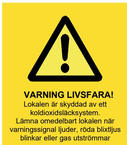
Exempel Varningsskylt insida dörr
