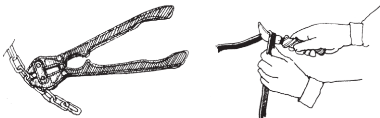
Figur 3.3 Bultsax bör ha en skänkellängd på minst 0,6 meter. Exempel på lämpligt utformad kniv.
