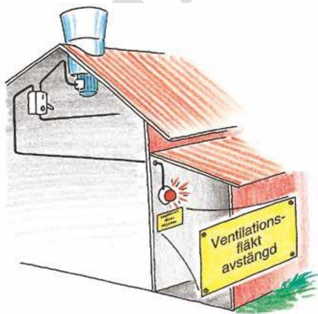
Figur 13. Där funktionen är mycket viktig bör det finnas indikering om att lastfrånskiljaren är frånslagen.
