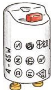
Figur 7.3a. Exempel på säkerhetsglimtändare. Med säkerhetsglimtändare minskar risken för brand och de ska finnas i alla plastkapslade lysrörsarmaturer.
