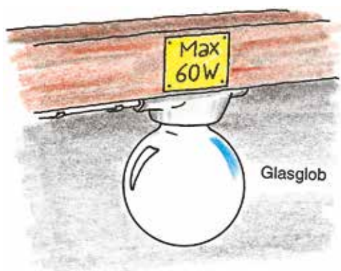
Figur 7.4. Skyddsglob ska alltid vara monterad.
