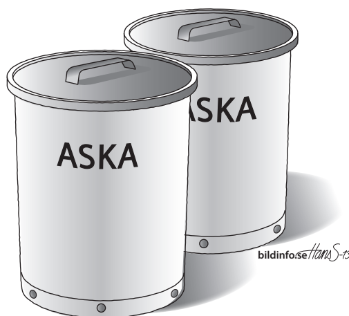
Figur 3.8 Förvaring av aska ska ske i på ett säkert sätt i askbehållare i stålplåt
