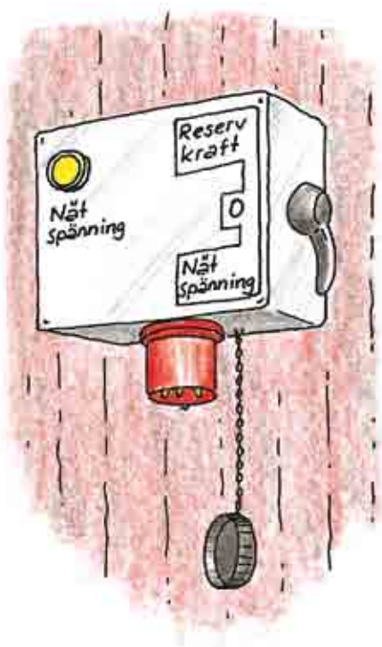
Figur 23b. Mobila reservverk ansluts via speciella reservkraftsintag. Även om man inte har ett eget reservverk ska reservkraftsintag finnas
