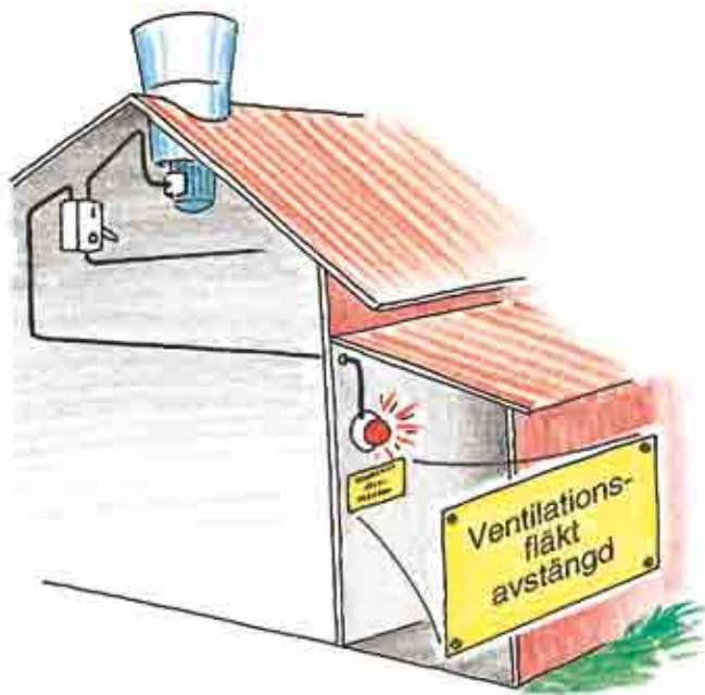
Figur 13. Där funktionen är mycket viktig bör det finnas indikering om att säkerhetsbrytaren är frånslagen.
