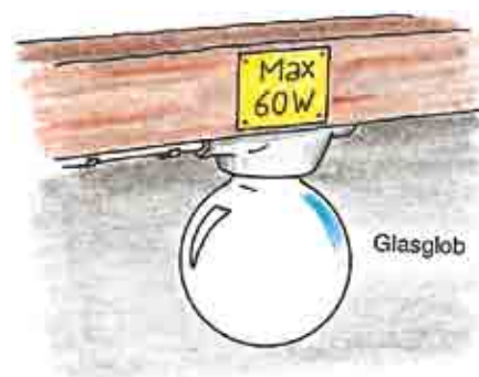
Figur 7.4 Skyddsglob ska alltid vara monterad.
