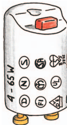
Bild 9. Exempel på säkerhetsglimtändare. Med säkerhetsglimtändare minskar risken för brand och ska finnas i alla plastkapslade lysrörsarmaturer.
