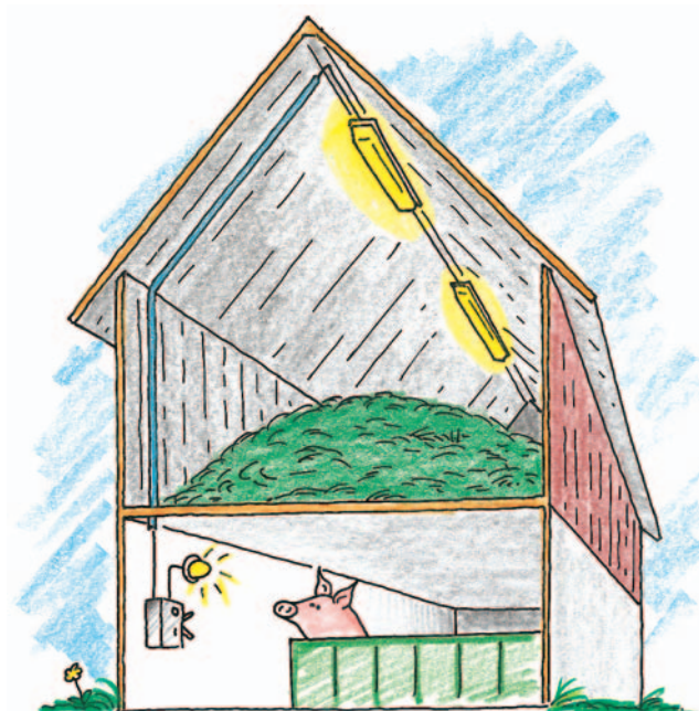
Bild 12. Belysningar som manövreras från en plats där man inte ser om de är till- eller fränslagna bör förses med någon form av indikering.
