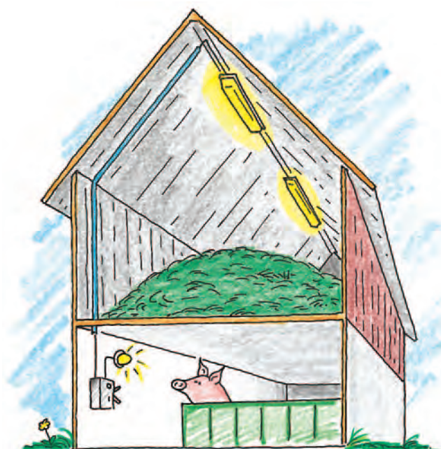
Bild 12. Belysningar som manövreras från en plats där man inte ser om de är till- eller frånslagna bör förses med någon form av indikering.
