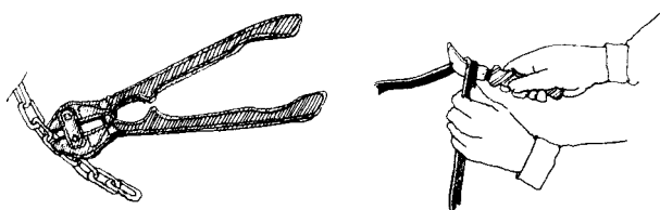
Figur 8.1 Exempel på lämpligt utformad kniv. Bultsaxen bör ha en skänkellängd på minst 0,6 m.
