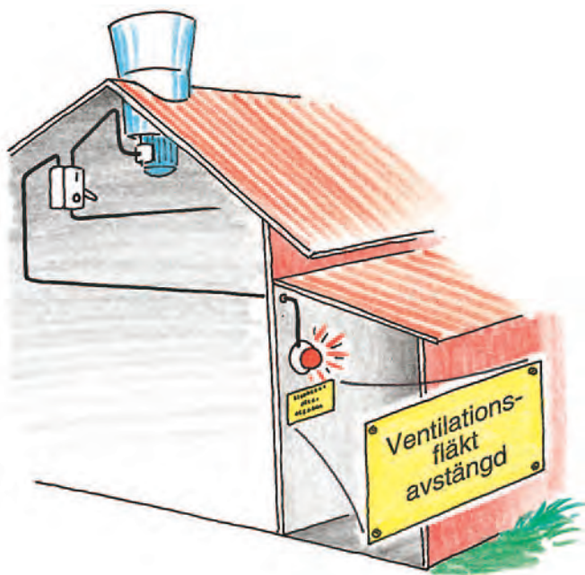
Bild 18. Där funktionen är mycket viktig bör det finnas indikering om att säkerhetsbrytaren är frånslagen.
