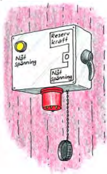
Bild 31. Mobila reservverk ansluts vanligtvis via speciella reservkraftintag. Även om man inte har ett eget reservverk rekommenderas att man installerar reservkraftintag i samband med nybyggnad eller större ombyggnad av elinstallationen.
