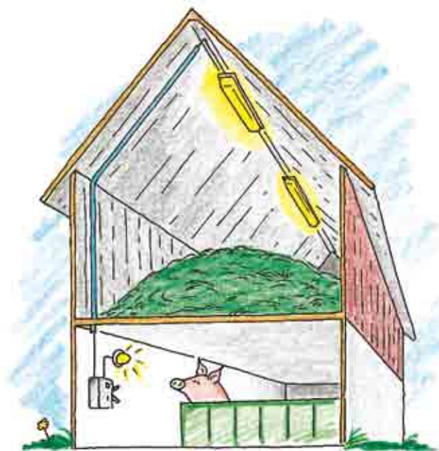
Figur 7.5b Belysningar som manövreras från en plats där man inte kan se om de är till- eller frånslagna bör förses med någon form av indikering.
