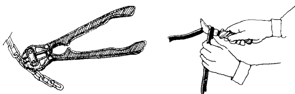
Figur 2.4 Bultsax bör ha en skänkellängd på minst 0,6 m. Exempel på lämpligt utformad kniv.
