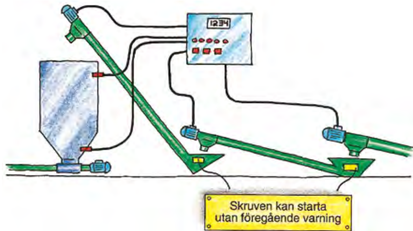
Figur 14. Utrustning som fjärrstyrs eller startas automatiskt måste försees med varningsskyltar.
