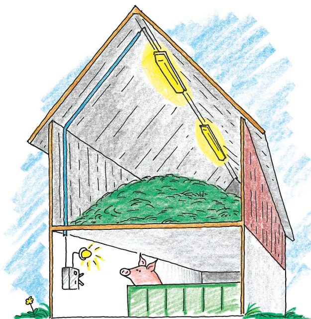
Figur 7.5a. I lokaler där hö och halm lagras är det extra viktigt att armaturerna placeras så att de inte skadas i samband med hantering av foder.
