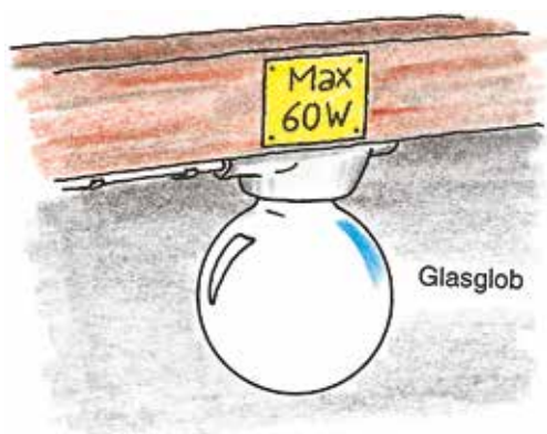
Figur 7.4. Skyddsglob ska alltid vara monterad.
