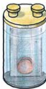
Figur 7.3b. Även elektroniska glimtändare fungerar som säkerhetsglimtändare,
