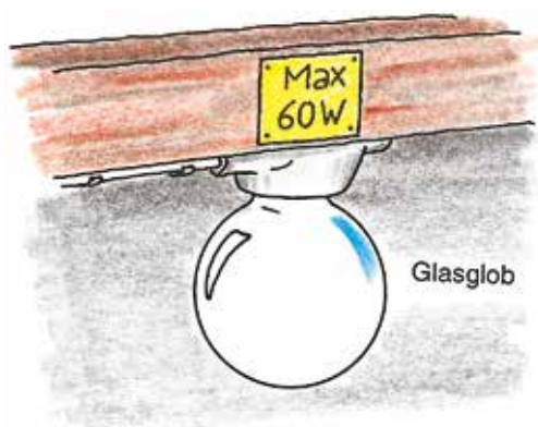
Figur 7.4. Skyddsglob ska alltid vara monterad.
