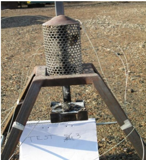
Försök 3, Eclipse 3 Cu-platta är från detta försök och framåt belagd med svart färg
